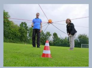
Ein Ball wird auf einen Metallring gelegt, an dem Schnüre befestigt sind.
