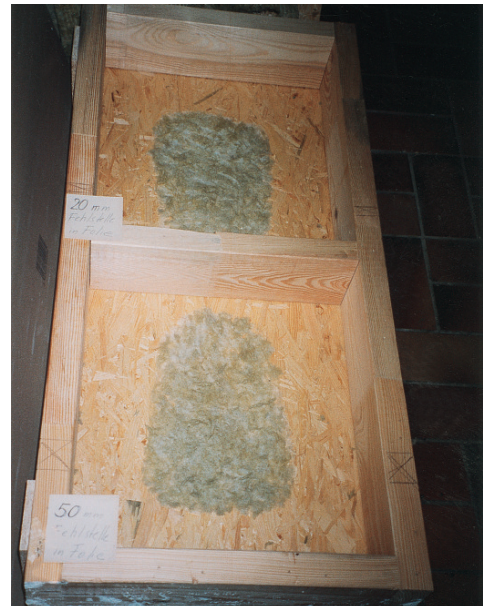
Abb. 2b: Nach Öffnen zum Versuchsende bleibt durch geringe Eisbildung teilweise die Mineralwolle an der äußeren OSB haften.
