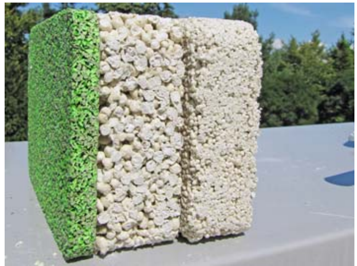
Abb. 2: Zeigt an einem Modell den Aufbau aus EPDM-Granulat an der Oberfläche und gebundenem Schaumglas mit unterschiedlichen Körnungen als Unterbau.
